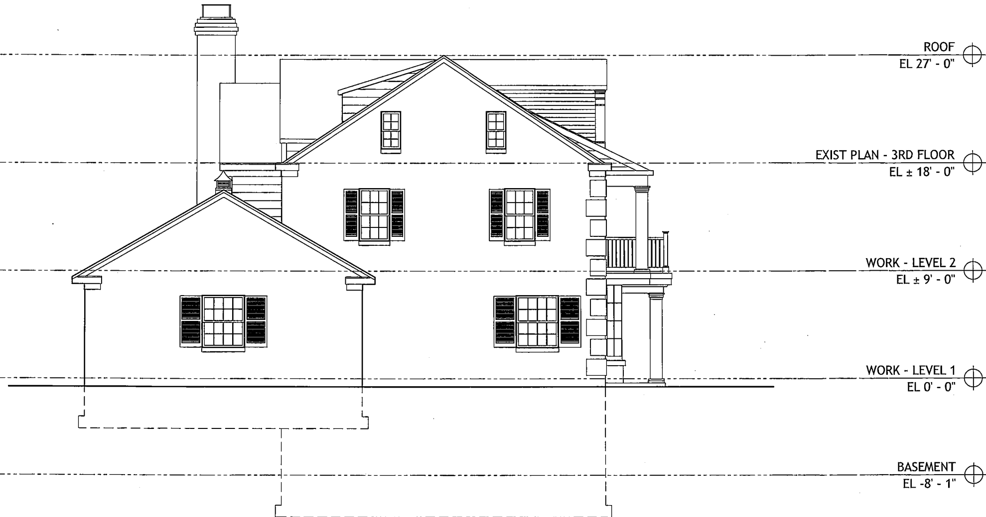
2 EXISTING LEFT SIDE ELEVATION SCALE: 1/8" = 1'-0"
